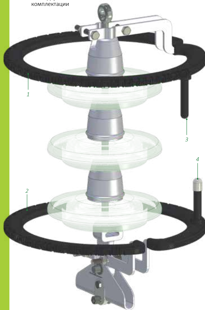
Рис. 20. Общий вид разрядника РМКЭ-35 в стандартной комплектации
