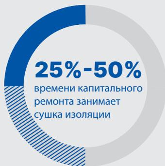
**Повышенная влажность изоляции влияет на трудоемкость и качество ремонтов – на межремонтный период**
