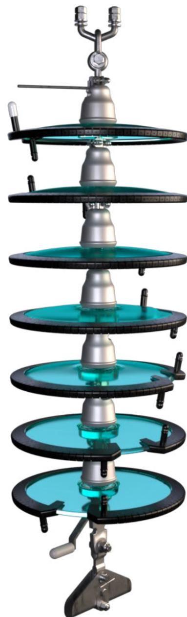
ГИРМК-110 (гирлянда мультикамерных изоляторов-разрядников) предназначена для использования одновременно в качестве линейной изоляции и разрядника для молниезащиты воздушных линий электропередачи (ВЛ) трехфазного переменного тока класса напряжения 110 кВ.
