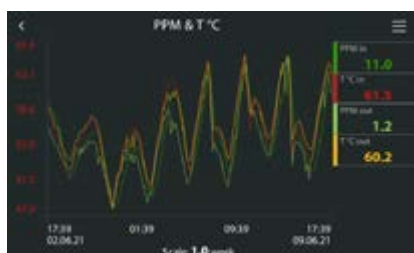
Тренды абсолютной влажности масла и температуры
