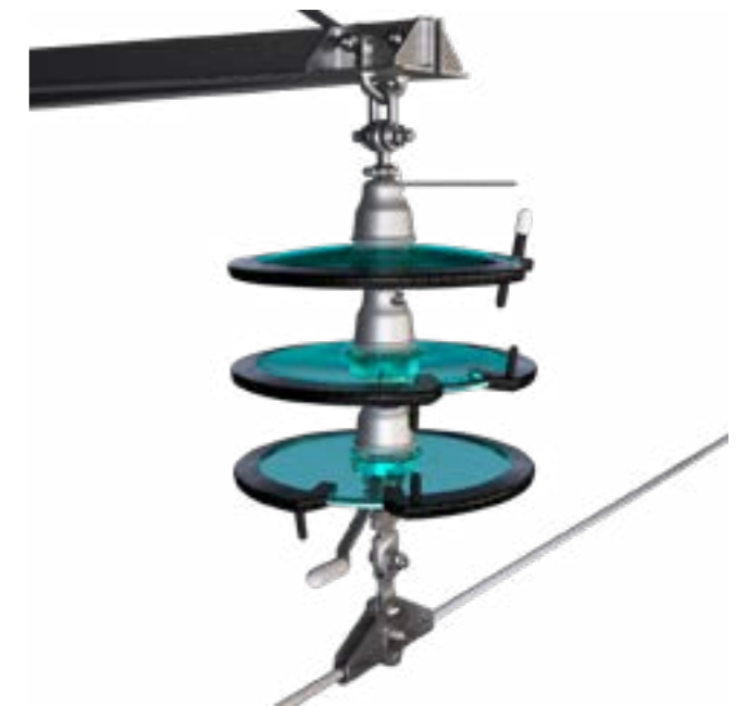
Рис. 22. Установка ГИРМК-35 на промежуточной опоре
