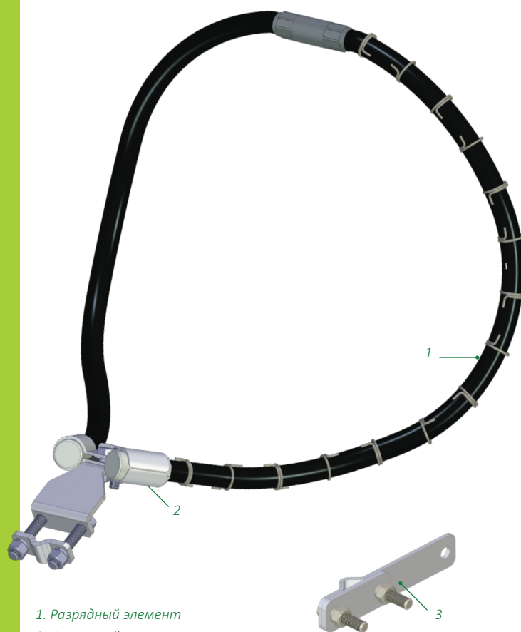
Рис. 25. Общий вид разрядника РДИП-10-IV-УХЛ1 в стандартной комплектации
