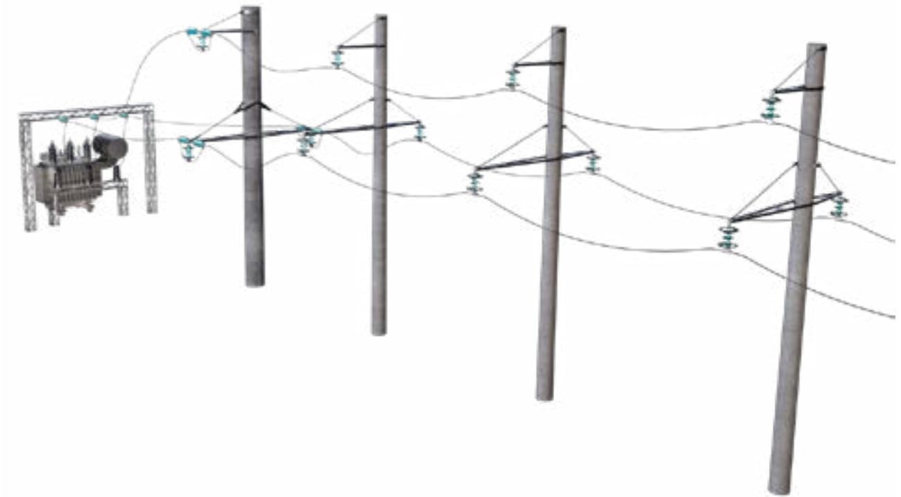
Рис. 29. Защита подхода ВЛ 35 кВ к подстанциям
