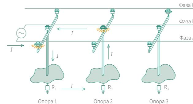
Схема 4. Схема установки разрядников ИРШФМК-10(20) на ВЛ
