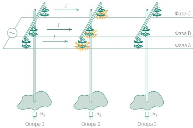
Схема 7. Схема установки разрядников РМКЭ-35 на ВЛ
