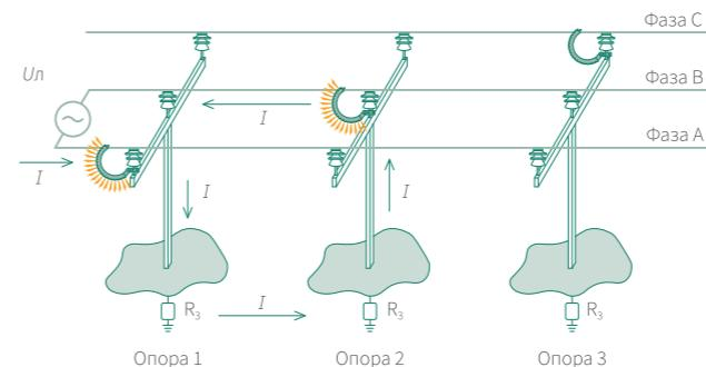
Схема 3. Схема установки разрядников РМК-20 на ВЛ
