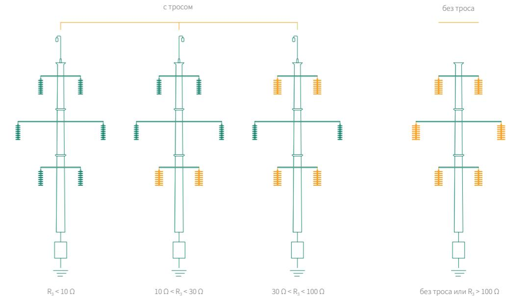
Схема 9. Рекомендации по выбору количества разрядников на двухцепной ВЛ в зависимости от величины сопротивления заземления
