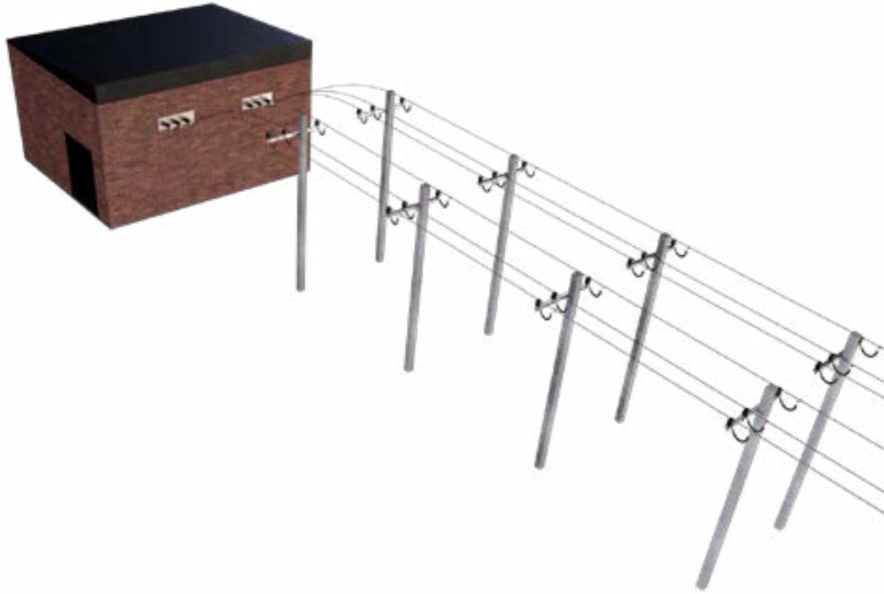
Рис. 28. Защита подхода ВЛ 6,10 кВ к подстанциям
