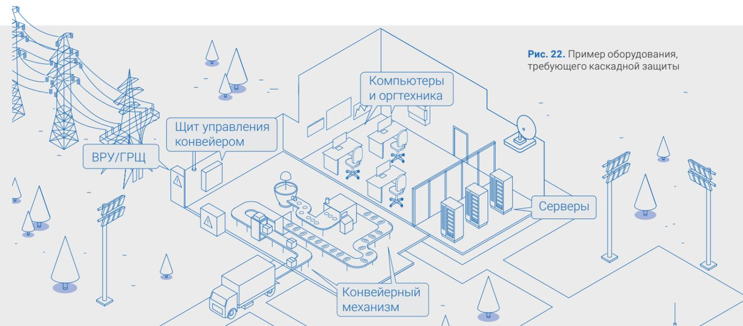
Рис. 22. Пример оборудования, требующего каскадной защиты
