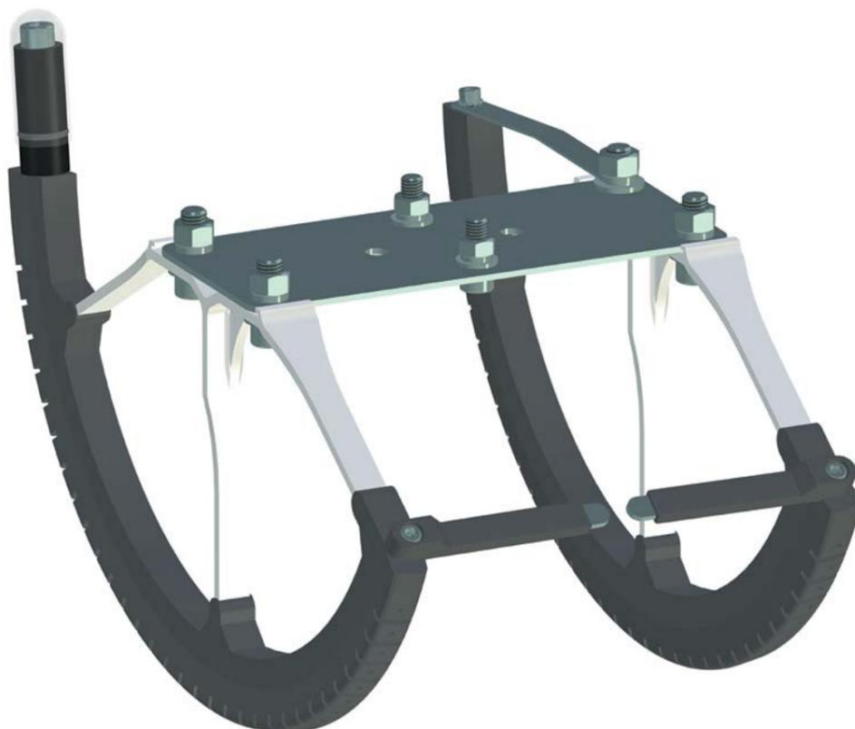
Итак, несколько лет назад в «Стримере» появилась идея создать разрядник экранного типа РМКЭ-35. Когда продукт из идеи стал рабочим прототипом, решили сделать разрядник, состоящий не из двух, а из одного кольца, и предназначенный для линий напряжением 20 кВ. Так в линейке решений появилось оборудование, способное защищать от прямого удара молнии воздушные линии 20 и 35 кВ.
